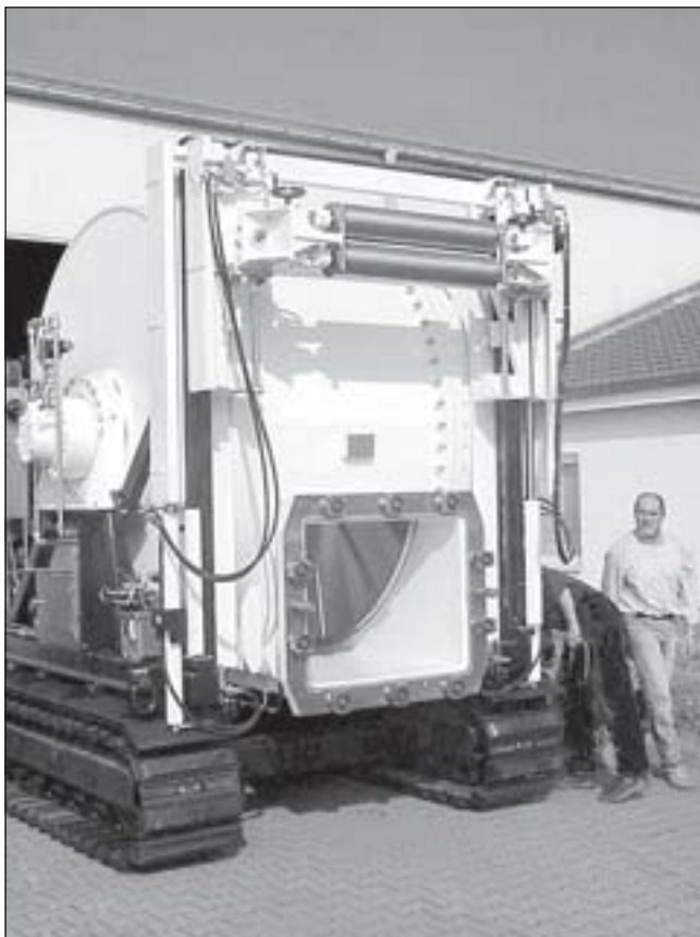
Obr. 3 – Samohybný tlakový reverzační buben
