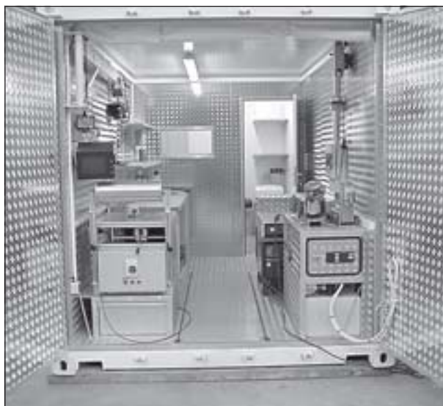
Obr. 4 – Zařízení pro kamerovou inspekci úseků až 1 000 m dlouhých
