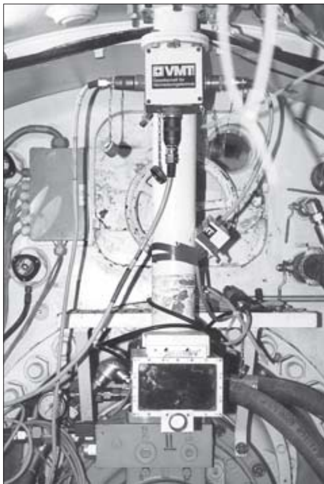
VMT navigační systém umístěný na předě štítu
