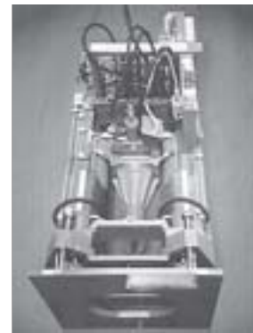
Zařízení hydros®PLUS s opěrnou deskou zavěšenou na hydraulických válcích
